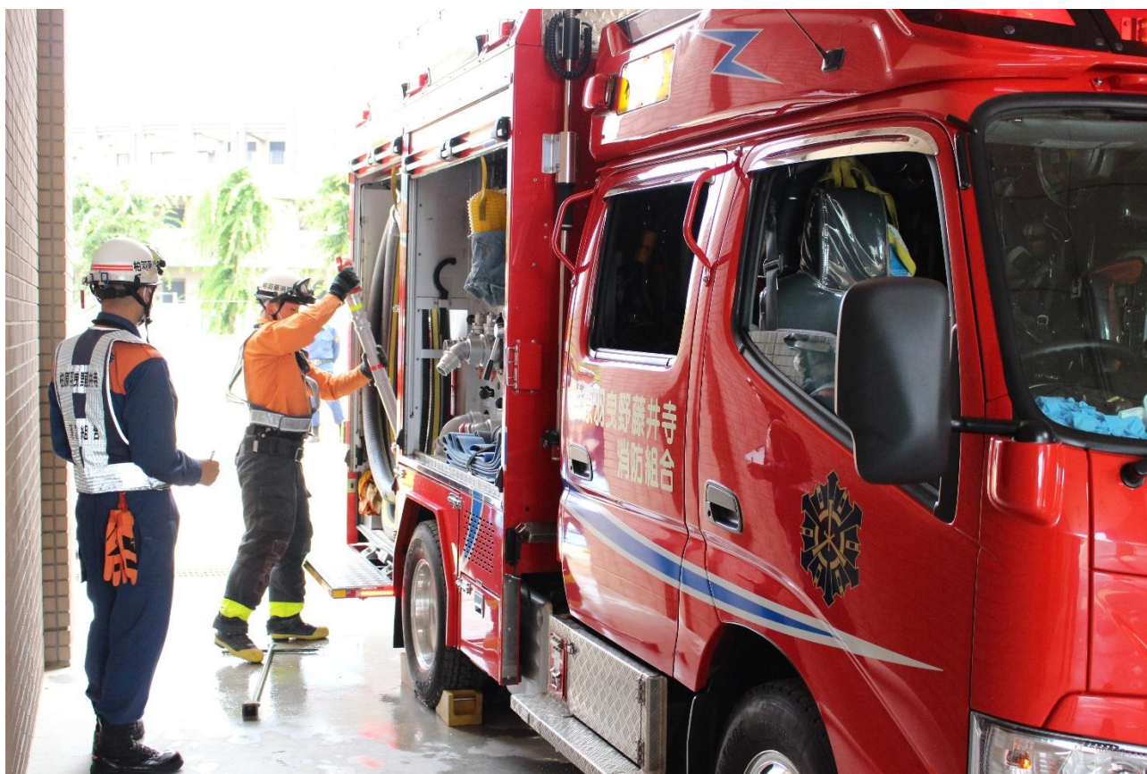
スタンドパイプと消火栓蓋開け用資機材の搬送準備
